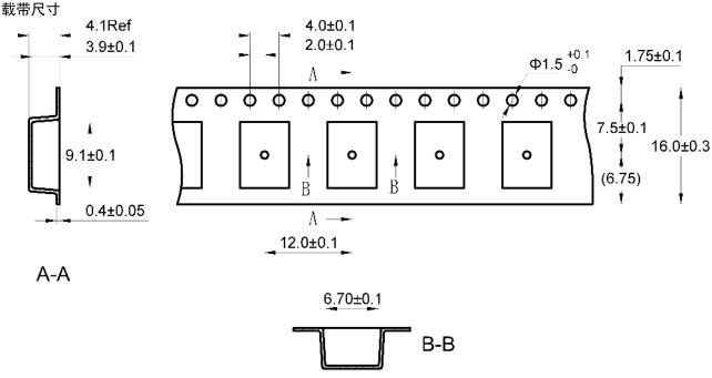
※ Packing is referred to the international standard IEC 60286-3. 包装参照国际标准 IEC 60286-3。
